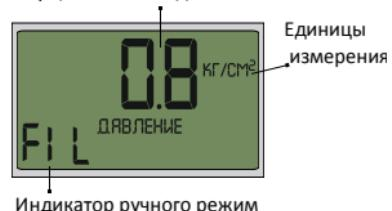
предназначен для ручного заполнения системы, проверки герметичности и т.д.
