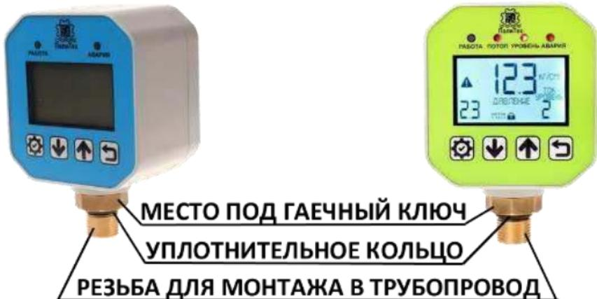
Рисунок 1. Схема монтажа на трубу.
