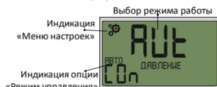
– опция выбора режима управления. Можно задать режим долговременной автоматической работы, режим работы по датчикам уровня в водонапорном баке
