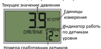
работы в этом режиме укажите в опции 2.3 режим **LEU** и подключите датчики уровня (подробнее см. раздел «Монтаж»).
