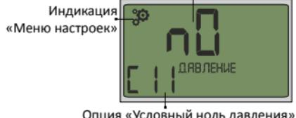
позволяет привязать ноль давления прибора к условному давлению на входе. Контроллер будет показывать положительную разницу между давлением
