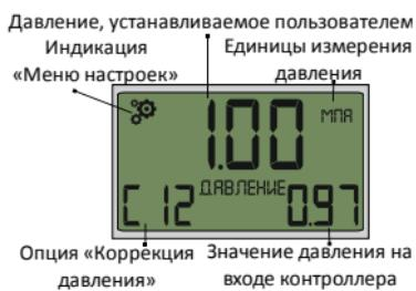
опция, позволяет изменить шкалу давления. Используется для калибровки прибора в процессе эксплуатации.
