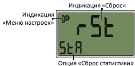
рабочего времени и статистику по объему воды, прошедшей через импульсный датчик расхода, если он подключен к контроллеру. Для выбора нужного
